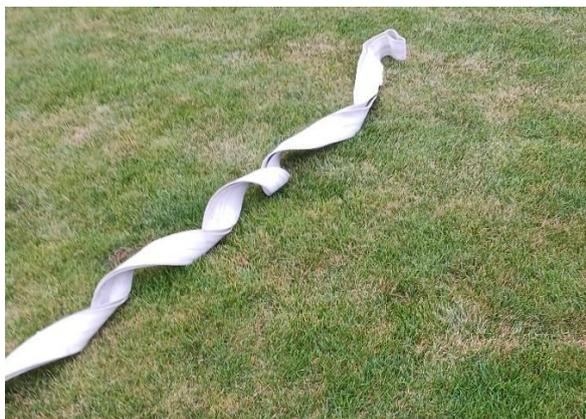
Abb.33a: Schlecht ausgelegter Druckschlauch
