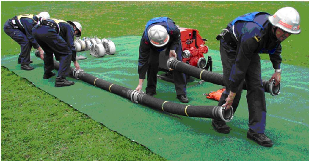
Abb. 8b: Tragen der Saugschläuche durch den WTR und das Auslegen des Saugschlauches durch den STR
