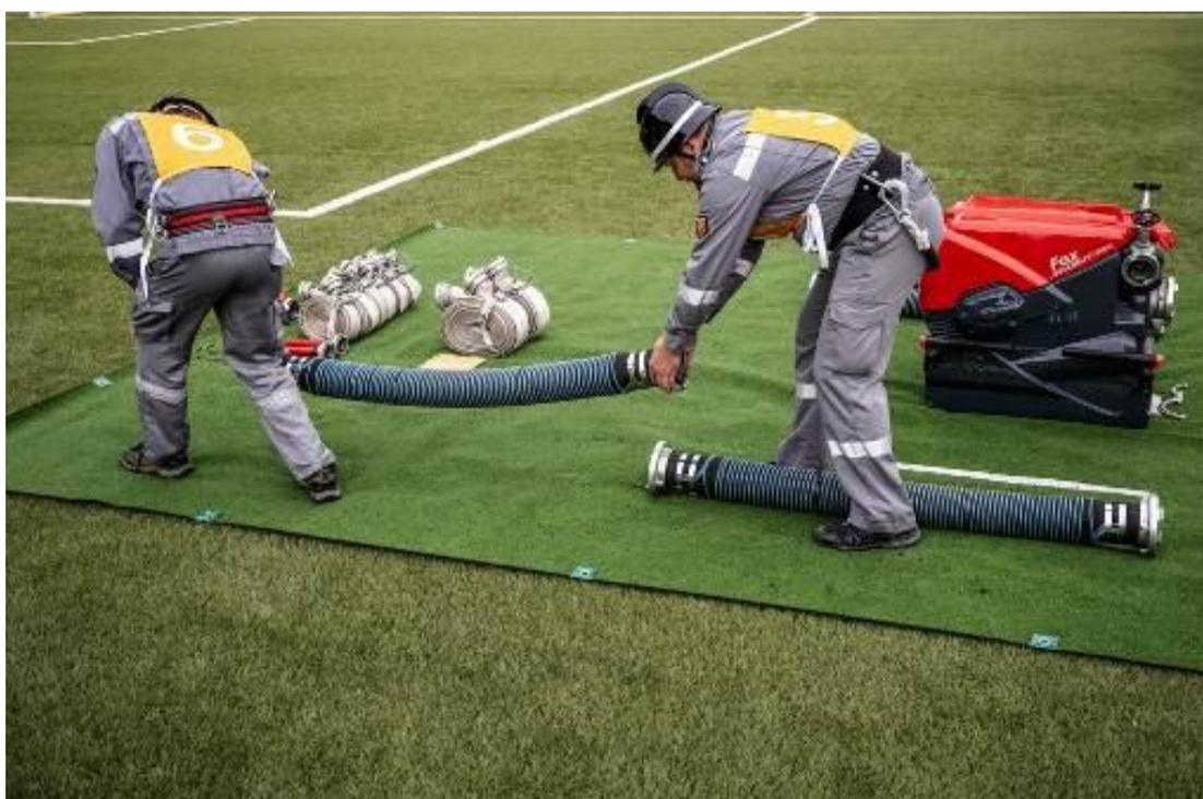
Abb.8a: Auslegen der Saugschläuche durch den Schlauchtrupp
