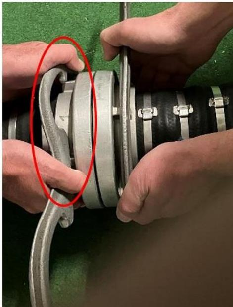
**Fehler**, weil beim Kupplungsvorgang nicht der A-Bogen, sondern der B-Bogen verwendet wird
