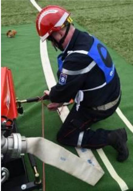
Abb.26: Befestigen Saugschlauchleine an der TS
