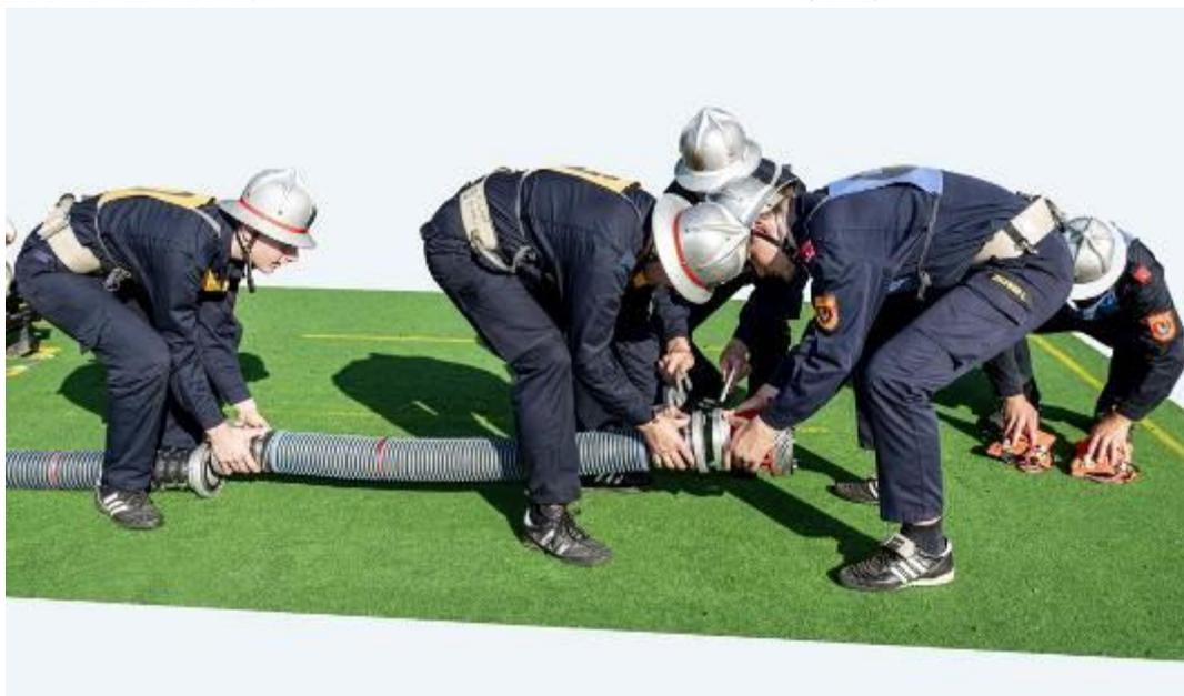
Abb.11: Aufnahme des ersten Saugschlauches zum Ankuppeln des Saugkorbes.....
