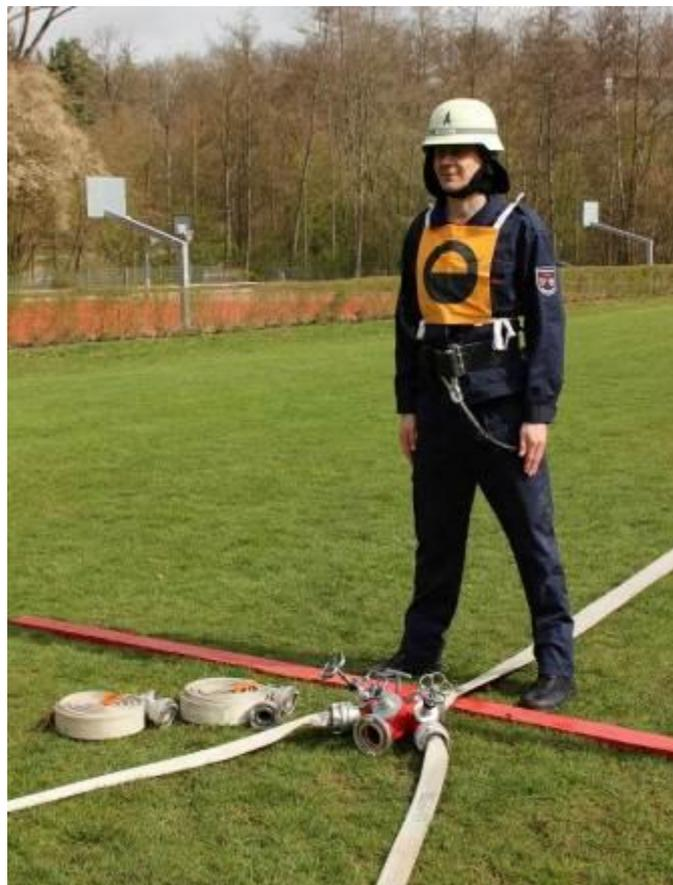
Abb.34: Besetzen des Verteilers durch den Schlauchtruppführer
