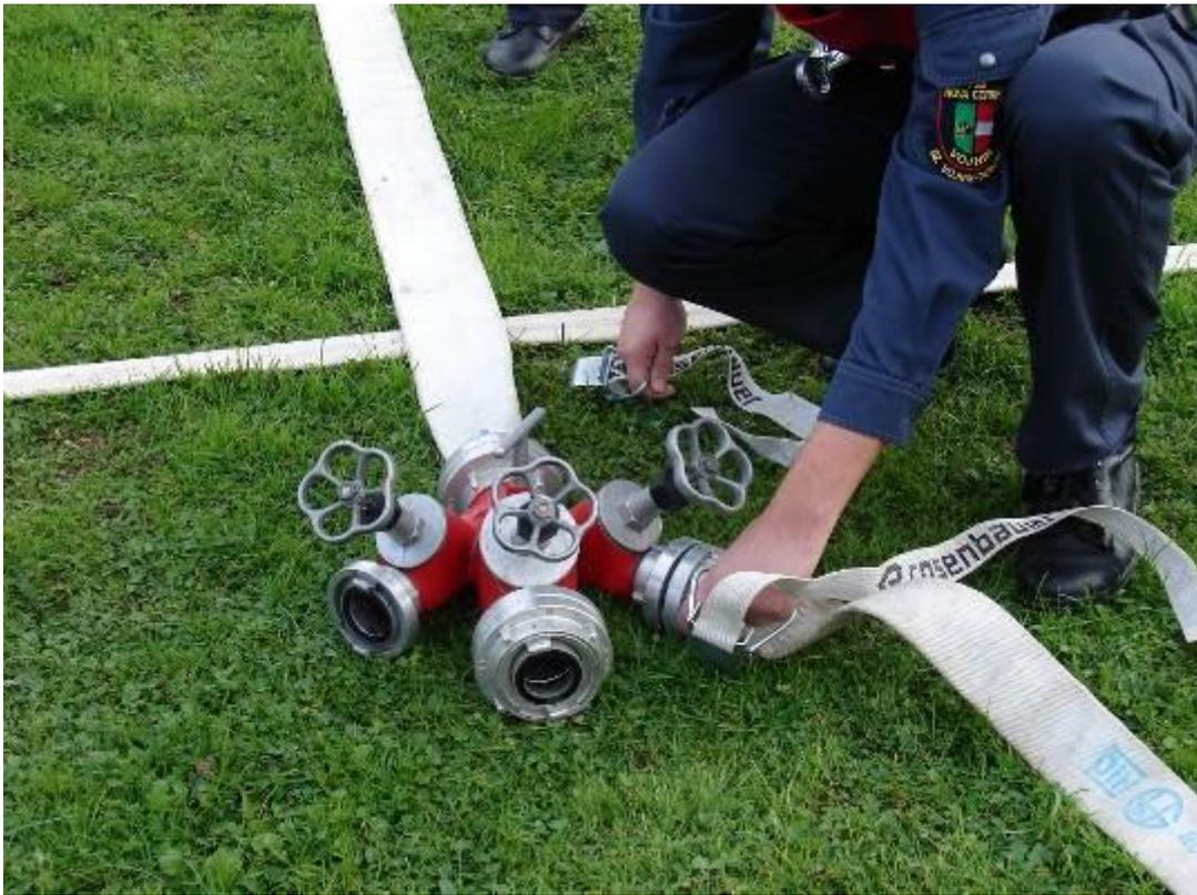
Abb.30: Anschließen der ersten Löschleitung
