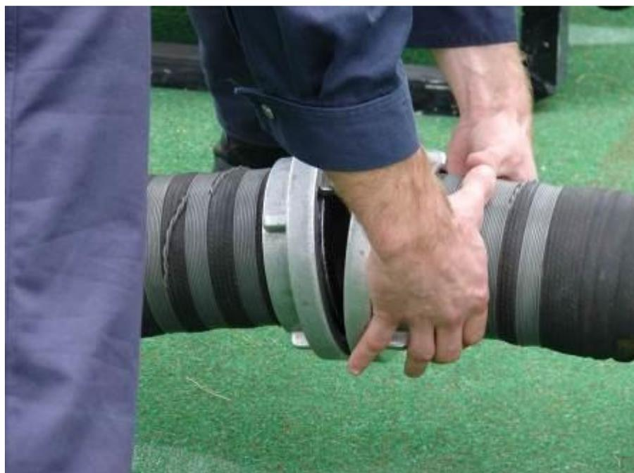
Abb.16b: Nur der zu kuppelnde Saugschlauch darf vom Schlauchtruppmann berührt werden
