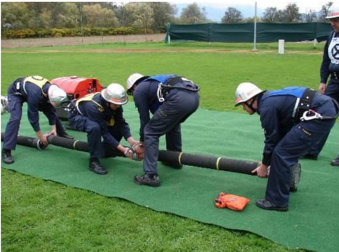
Abb.16: Kuppeln der Saugschläuche durch Wassertrupp und Schlauchtrupp
