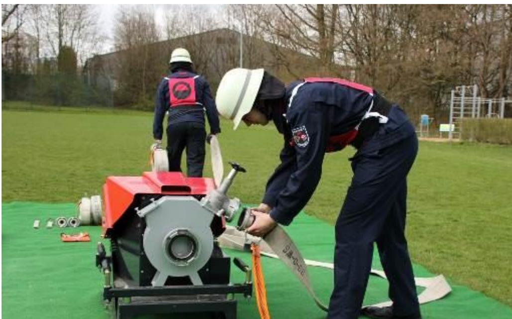
Abb.27: Ankuppeln und Auslegen des ersten B-Schlauches
