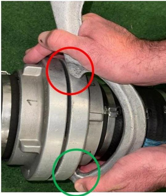
Fehler, weil nur eine „Nase“ des Kupplungsschlüssels die „untere Fläche der Kupplung“ berührt
