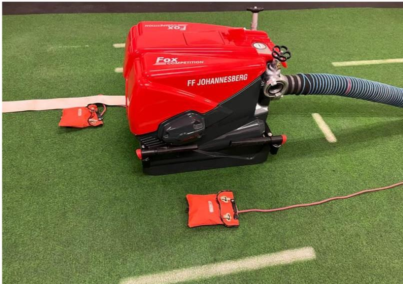
Abb.25: Ablegen des Leinenbeutels mit der Ventilleine
