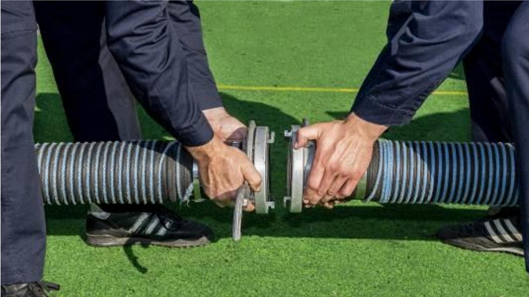
Abb.16a: Kuppeln der Saugschläuche durch Wassertrupp und Schlauchtrupp
