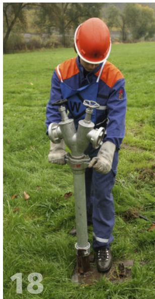
Dabei ist das Standrohr zu setzen, der Unterflurhydrant durch mindestens zwei volle Schlüsselumdrehungen zu öffnen und zu spülen. Die Drehrichtung des Unterflurhydrantenschlüssels ist nicht zu berücksichtigen.
