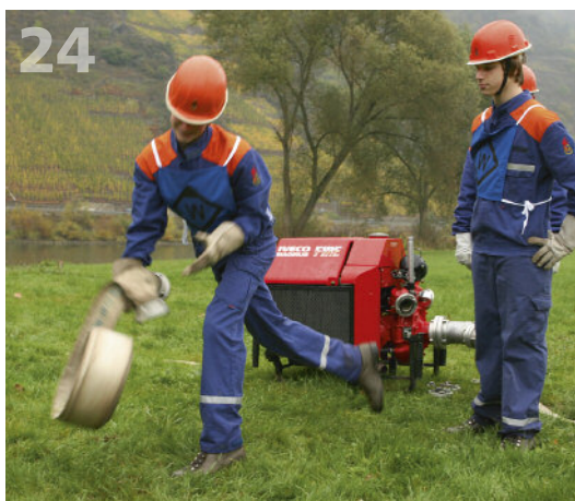
Nachdem die Wasserversorgung zum Unterflurhydranten hergestellt ist, verlegt der Wassertrupp den B-Druckschlauch ohne Schlauchverdrehung durch den Wassergraben bis zum Verteiler.
