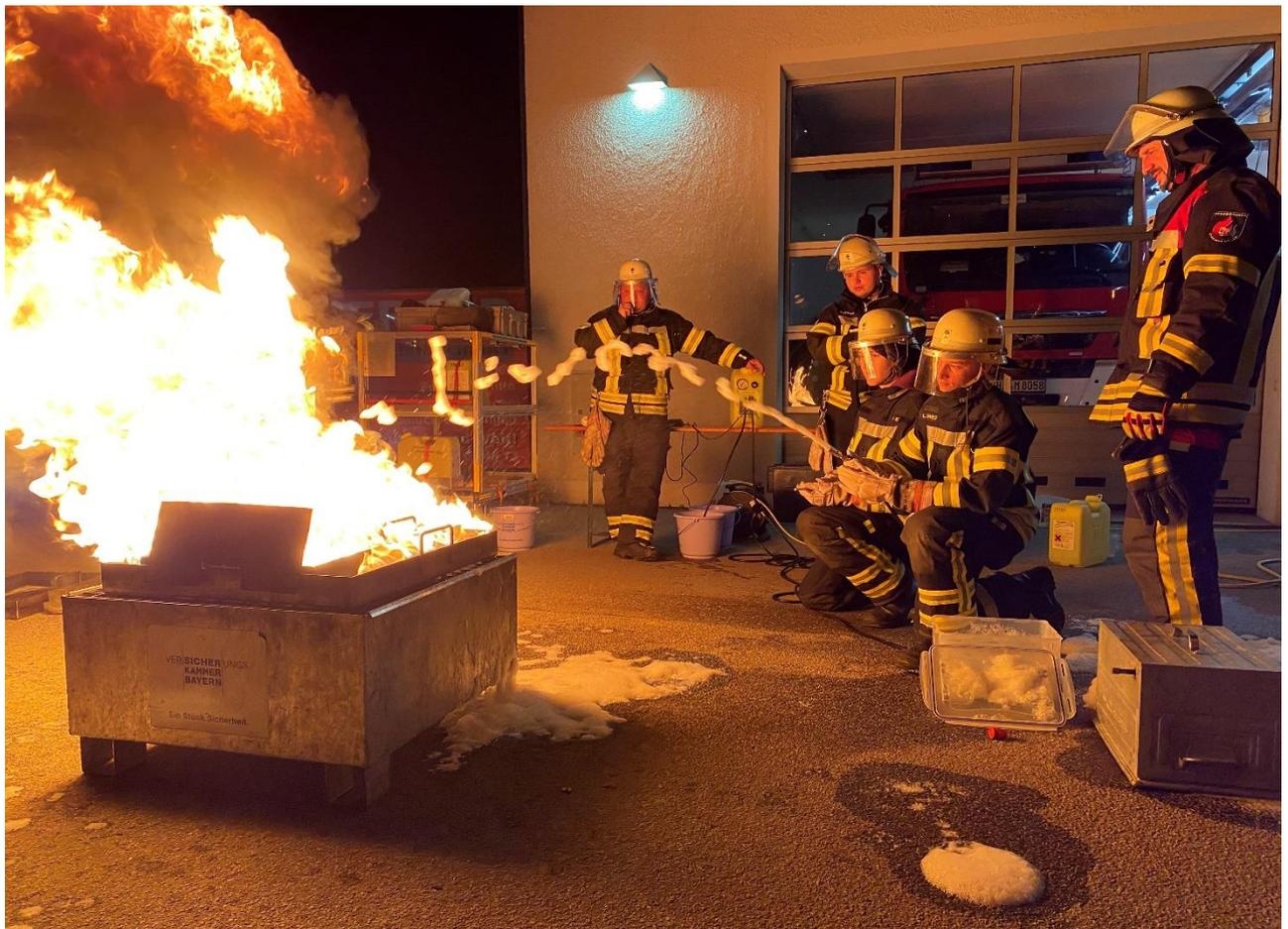
Die Auswirkung beim Auftragen verschiedener Schaummittel (alkoholbeständig, Mehrbereichs-schaummittel usw.) lassen sich mit Schaumtrainer nachstellen.
