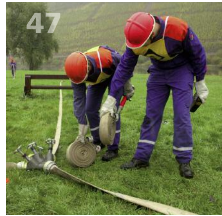
Am Verteiler nimmt der Schlauchtrupp zwei doppelt gerollte C-Druckschläuche
