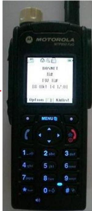
Bei den Prüfungen ist darauf zu achten, wie hoch die Feldstärke auf dem Funkgerät angezeigt wird und ob ein Gespräch im TMO (Netzmodus) möglich ist. Zu beachten ist, dass die Feldstärke negativ angezeigt wird. Dies bedeutet, je höher die Zahl ist desto schlechter ist die Feldstärke und desto schlechter ist der Empfang. In der Nähe einer Basisstation liegt die Feldstärke bei ca. -35 bis -45 dBm, bei über -110 dBm bucht das Gerät aus.
