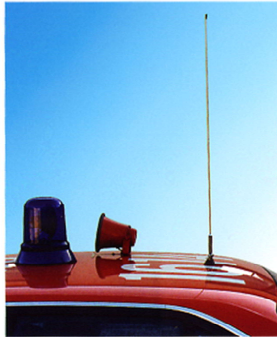
\lambda/4 - Strahler z. B. für Fahrzeug- Funkanlagen
