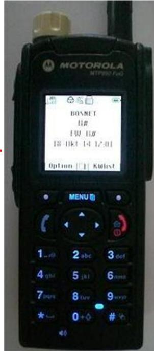
Bei den Prüfungen ist darauf zu achten, wie hoch die Feldstärke auf dem Funkgerät angezeigt wird und ob ein Gespräch im TMO (Netzmodus) möglich ist. Zu beachten ist, dass die Feldstärke negativ angezeigt wird. Dies bedeutet, je höher die Zahl ist desto schlechter ist die Feldstärke und desto schlechter ist der Empfang. In der Nähe einer Basisstation liegt die Feldstärke bei ca. -35 bis -45 dBm, bei über -110 dBm bucht das Gerät aus.
